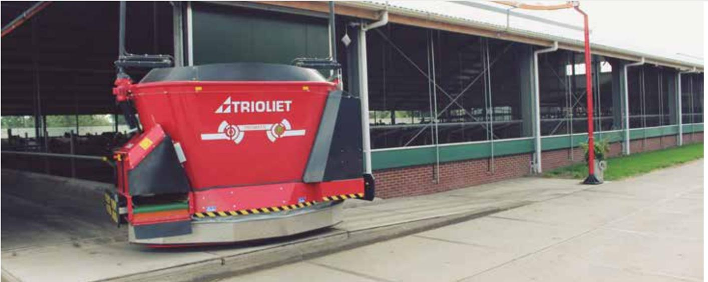
*Ein Fütterungsroboter eignet sich für 50 bis 700 GVE.
