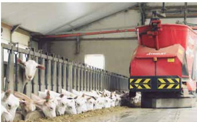
Die Fütterungsroboter haben zwei vertikale Mischschnecken und einen Inhalt von 2,5 oder 3 m<sup>3</sup> und eignen sich für 50 bis 700 GVE.
