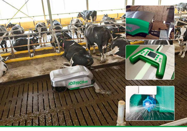
Der JOZ-Tech Entmistungsroboter ist ein vollautomatischer Roboter für die Reinigung von Milchviehställen. Aufgrund der hohen Leistung sind die Böden sauber, und das Wohlbefinden der Kühe wird verbessert.
