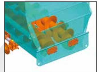
Sistema brevettato di trinciatura-miscelazione "Double Mix" a 2 coclee inferiori con elevata rapidità e precisione di lavoro.
