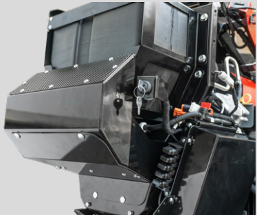
Erhöhter Ansaugkanal mit Motorschutzgitter und Zyklonluftfilter
